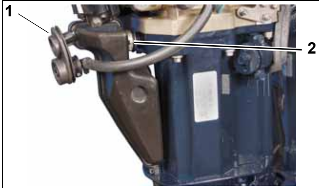
1. Overboard indicator grommet 2. Oetiker clamp
