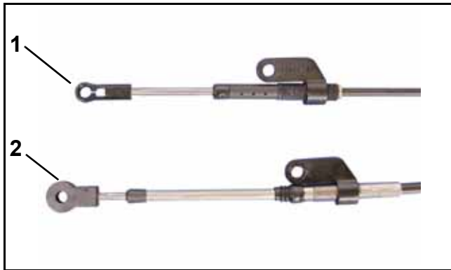
4. Throttle cable end 5. Shift cable end
