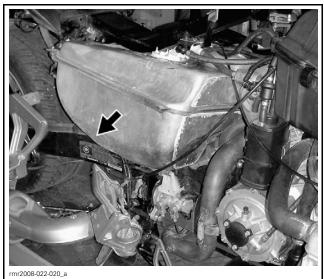
TYPICAL - LIFT AND PULL OUT OVER BRAKE OIL HOSES
