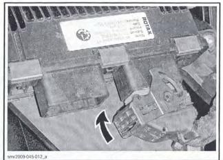
CONNECTOR LOCKING CAM ROTATION TO RELEASE
