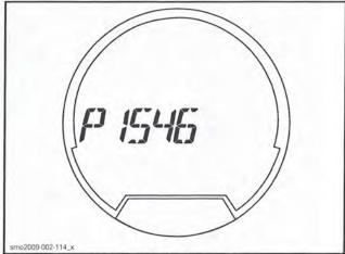
TYPICAL - ENGINE FAULT CODE EXAMPLE
