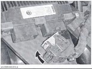
CONNECTOR LOCKING CAM IN RELEASE POSITION
