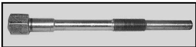
Удерживая ведущий шкив вариатора приспособлением (P/N 529 035 674), установите съемник в вал шкива вариатора и затяните.
