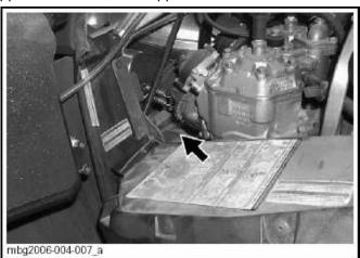
• Провести обследование нижней части кронштейна: сварной шов [С] должен полностью окружать трубку рулевой колонки.
