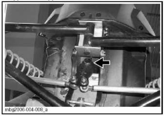
• Проведите обследование нижней части кронштейна: сварной шов [С] должен полностью окружать трубку рулевой колонки и кронштейн усиления.
