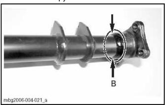
• Проведите обследование нижней части рулевой колонки. Наблюдение проводится под снегоходом.
