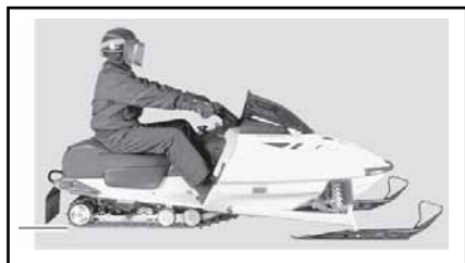
СЛИШКОМ МЯГКАЯ РЕГУЛИРОВКА ПОДВЕСКИ
