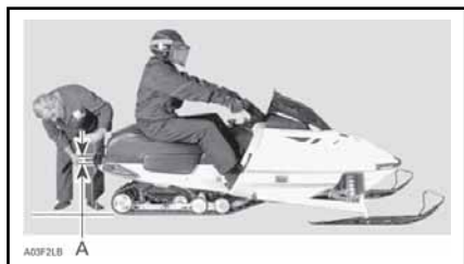
ПРАВИЛЬНАЯ РЕГУЛИРОВКА: 50-75 мм
