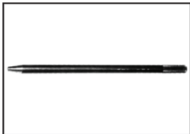
Стопор распределительного вала P/N 529 035 839 Обязательное Двигатели V1000, V1300 и 1503
