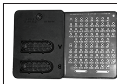
Адаптер ECM P/N 420 277 010 Обязательное Все модели Все инжекторные двух- и четырех- тактные с VDO ECM
