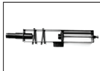
Приспособление для снятия пружины P/N 529 036 007 Рекомендуемое Все модели Для снятия пружины с амортиза- тора
