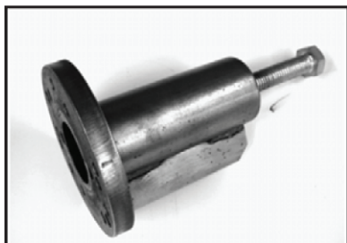
Приспособление для снятия подшипника коленчатого вала P/N 529 036 004 Рекомендуемое Двухтактные двигатели
