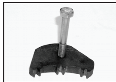
Приспособление для стопорения зубчатого венца P/N 529 035 946 Рекомендуемое Двигатели 947 и 947 DI
