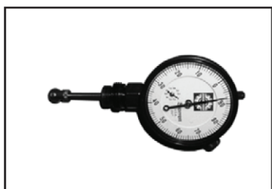
Индикатор часового типа для определения ВМТ P/N 295 000 143 Рекомендуемое Двухтактные двигатели за исключением DI, 1203
