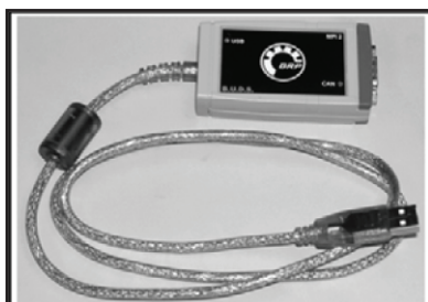
MPI-2 P/N 529 036 018 Обязательное Заменяет MPI
