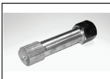
Приспособление для снятия уста- новки импеллера P/N 529 035 956 Обязательное Модели SC IC Приспособление используется для снятия и установки импеллера
