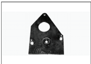
Крепёжная пластина P/N 529 035 947 Обязательное 4-TEC 1503 SC Для крепления нагнетателя в сборе в тисках при сборке/разборке
