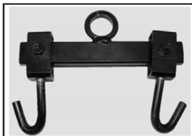
Крюки для подъёма двухтактных двигателей P/N 529 035 940 Рекомендуемое Все двухтактные двигатели
