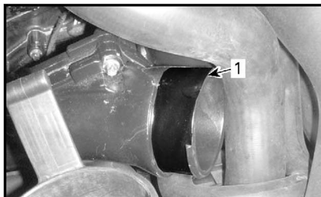
1. Очистите затемненную поверхность по всему диаметру на фланце механического нагнетателя
