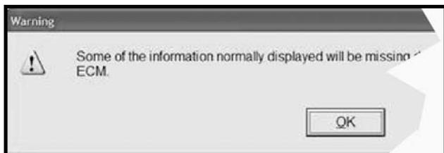
Предупреждение: «Часть информации отображаемой в обычном режиме будет отсутствовать из-за ошибки связи с ECM».
