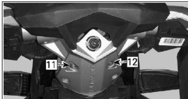
ЗАДНЯЯ ПРОСТАВКА РУЛЕВОЙ КОЛОНКИ
