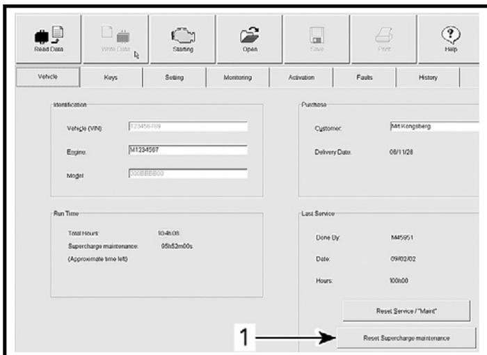
1. Кнопка обнуления отсчета сервисного интервала обслуживания механического нагнетателя
