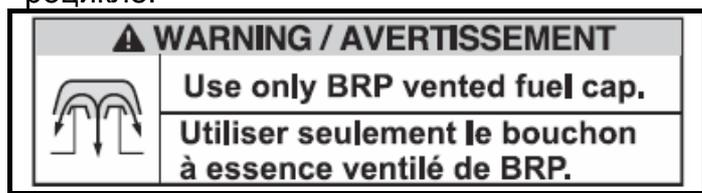
В случае если требуется замена крышки топливного бака на моделях имеющих вышеуказанную предупреждающую наклейку, используйте ТОЛЬКО ОРИГИНАЛЬНУЮ крышку вентиляции топливного бака производства BRP.
