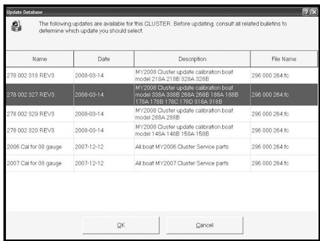
В описании, по модельному году или номеру модели, можно будет определить какой файл калибровки необходимо установить (номер модели или модельный год можно найти на вкладке "Vehicle" в поле "Identification").
