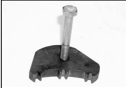
RING GEAR BLOCKING TOOL P/N 529 035 946 Mandatory 947 & 947 DI engines
