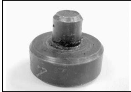
Crankshaft Protector P/N 420 877 414 Mandatory 947 DI engines
