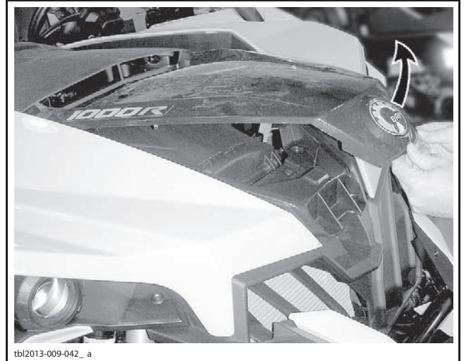
ПОЛНОСТЬЮ ПОДНИМИТЕ КРЫШКУ Снимите крышку радиатора.
