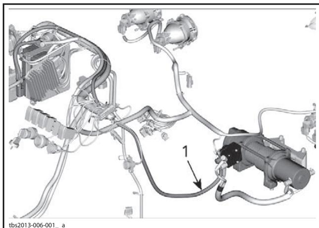
1. **ПРОКЛАДКА ПРОВОДОВ 2013:** Провода питания и «массы» прокладываются вместе, подходят к аккумуляторной батарее и располагаются около регулятора напряжения
