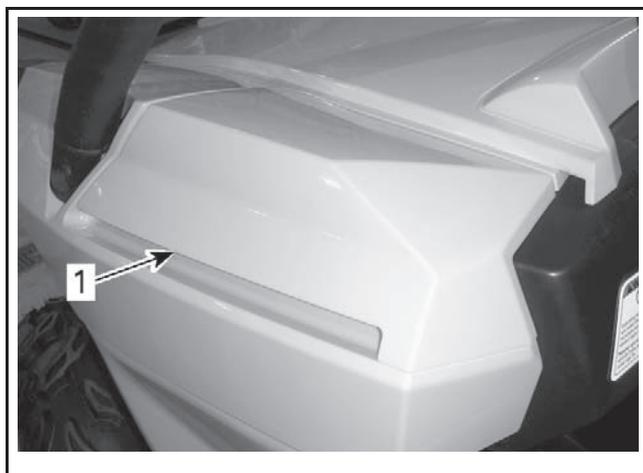
1. Снимите пластиковую крышку корпуса воздушного фильтра вариатора
