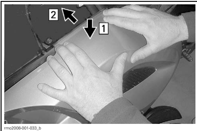
1. Press down top edge 2. Push top edge under top side panel edge
