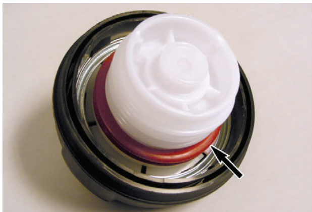
НОВАЯ КРЫШКА ТОПЛИВНОГО БАКА УСОВЕРШЕНСТВОВАННОЙ КОНСТРУКЦИИ – ЦВЕТ УПЛОТНИТЕЛЯ С ОТТЕНКОМ КРАСНОГО
