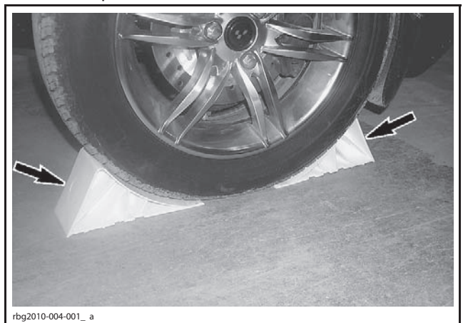
УСТАНОВКА ПРОТИВООТКАТНОГО УПОРА НА КАЖДОМ ПЕРЕДНЕМ КОЛЕСЕ
