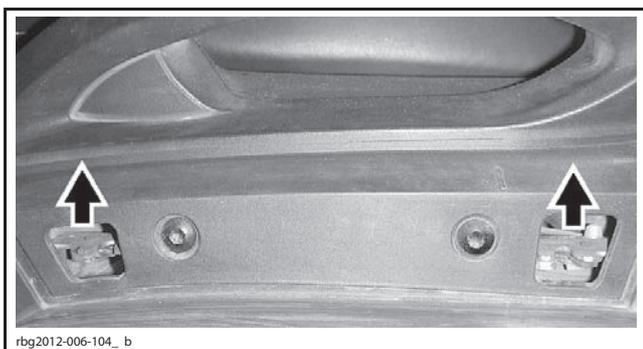
3. Затяните винты крепления фиксатора.
