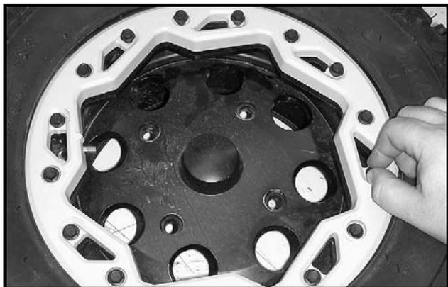
5. Используя динамометрический ключ, первично затяните винты фиксирующего кольца моментом 3 Н•м в порядке крест-накрест.
