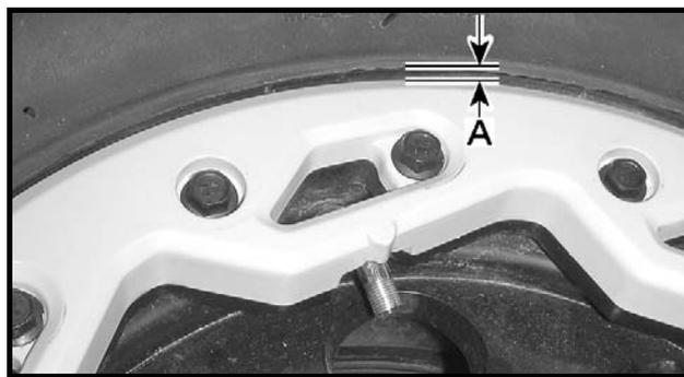
A. Одинаковый зазор по всей окружности крепежного обода фиксирующего кольца
