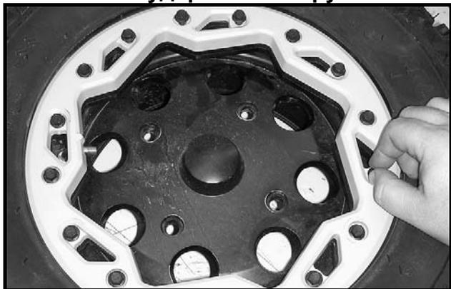
5. Используя динамометрический ключ, первично затяните винты фиксирующего кольца моментом  $3\text{Н}\cdot\text{м}$  в порядке крест-накрест.
