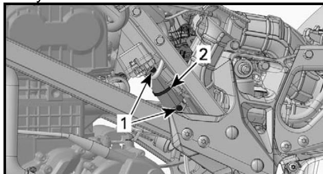
1. Винты крепления задней катушки зажигания.
