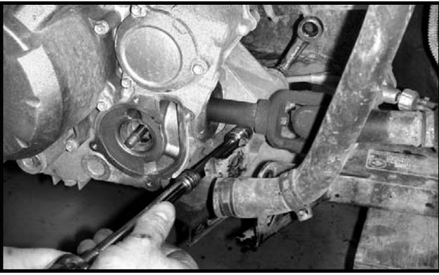
Передний нижний болт крепления двигателя
