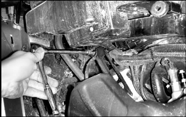
Передний верхний болт крепления двигателя
