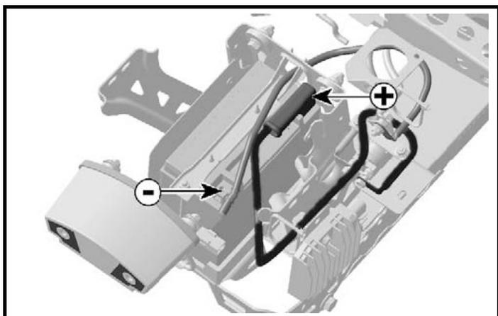
Установите АКБ на половину корпуса на штатное место. Плюсовая клемма АКБ должна быть обращена к передней части мотовездехода.
