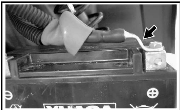
На фотографии выше показан правильный способ подключения к плюсовой клемме АКБ. Наконечник провода должен быть размещен именно так, как это показано на фотографии. Провод должен проходить над АКБ.
