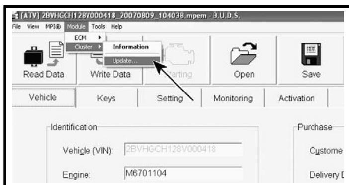
Подключитесь к мотовездеходу при помощи программного обеспечения BUDS. Считайте данные из электронного блока управления "Read Data". Войдите в меню Module; Cluster; Update.
