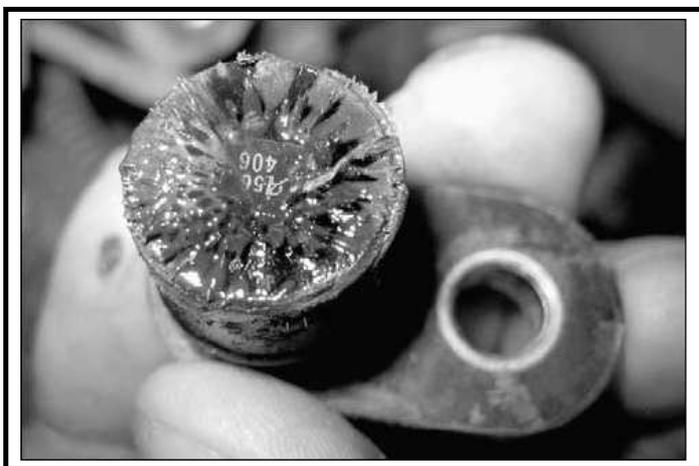
При работе датчик скорости может создавать более сильное магнитное поле по сравнению с аналогами. Таким образом, слишком большое количество металлической стружки внутри коробки передач может примагнититься к датчику скорости, создавая, таким образом, нежелательные помехи при считывании сигнала спидометром. Металлическая стружка образуется как в период обкатки,
