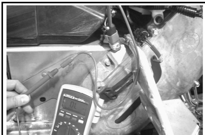
Для заказа доступен комплект пробников (P/N 529 036 063) для подсоединения к тыльной стороне электрических колодок. Комплект состоит из двух пробников с разными наконечниками.
